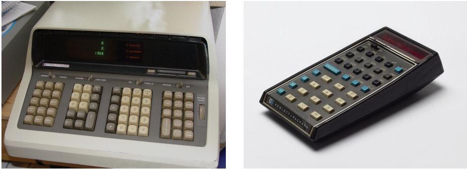
Abbildung 1: Der Tischrechner HP9100A (1968, links) und der Taschenrechner HP-35 (1972, rechts) von Hewlett-Packard. Beide Rechner verwenden die umgekehrte polnische Notation als Eingabemethode.
